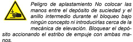
*Peligro de aplastamiento No colocar las manos entre el depósito de suciedad y el anillo intermedio durante el bloqueo bajo ningún concepto ni introducirlas cerca de la mecánica de elevación. Bloquear el depósito accionando el estribo de empuje con ambas manos.*
